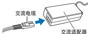
2. 将电源电缆插进 ScanSnap 后面的电源接口，另一端接到交流插座上。
