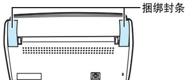
2. 打开 ADF 进纸斜槽（盖板）(1)、然后从叠纸器上拉开封条以取下泡沫保护材料 (2)。打开叠纸器 (3)、从 ADF 顶部 (4) 上拉开封条以取下保护盖。
