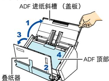
3. 拉开 ADF 开关以打开 ADF 顶部，然后拉开封条以取下卡板。
