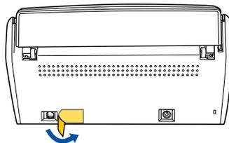
4. 将 USB 电缆连接到 ScanSnap 上的 USB 接口以及电脑的 USB 端口上。
