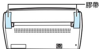
2. 打開 ADF 進紙槽 (掀蓋) (1)，然後撕開膠帶取出蓄紙器中的保護發泡板 (2)。打開蓄紙器 (3)，然後撕開膠帶取出 ADF 頂部 (4) 的保護板。
