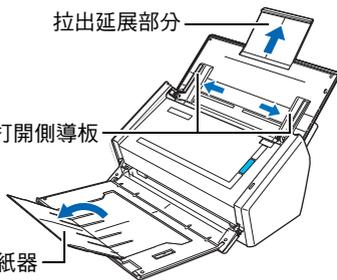
3. 將測試文件載入 ADF 進紙槽 (掀蓋)，並將側導板調整到文件寬度。
