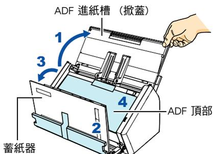
3. 拉起 ADF 開關以打開 ADF 頂部，然後撕開膠帶取出保護卡。
