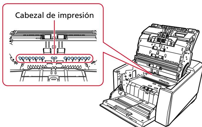
**6** Sostenga el ADF con ambas manos y empujelo hacia abajo lentamente. Empuje el ADF hasta que se bloquee.
