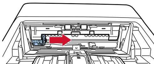
**4 Abra la tapa del sujetador del cartucho de impresión.**
