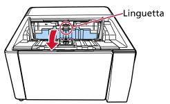
3 Spostare il portacartuccia di inchiostro in una posizione in cui sia possibile installare facilmente la cartuccia di inchiostro.
