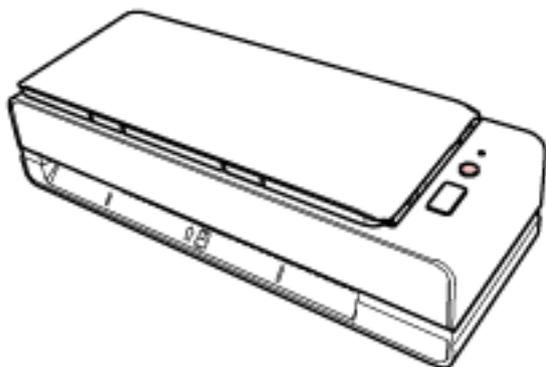
Le scanner est mis sous tension et le témoin DEL s'allume en vert.
