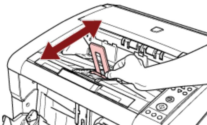
Для сканирования документов размера больше А3 вытащите удлинитель укладчика и удлинитель загрузочного лотка до конца.
