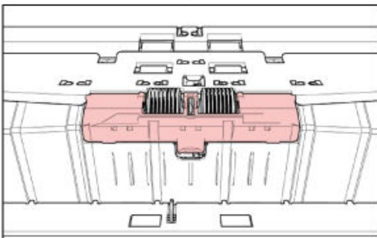
Дополнительная процедура, описывающая, как устанавливать тормозной валик на сканер, приведена ниже.
