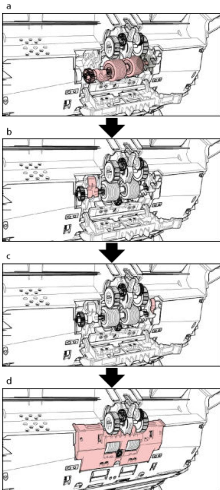
Дополнительная процедура, описывающая, как устанавливать разделительный валик в сканер, приведена ниже.
