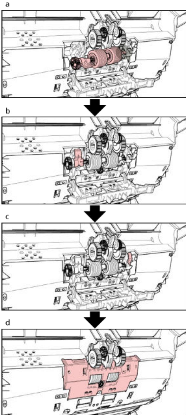
Di seguito è fornita una procedura aggiuntiva che descrive come installare il rullo di separazione nello scanner.
