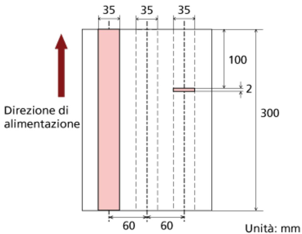
Poiché l'intervallo di rilevamento (lunghezza) è inferiore a 8 mm, le alimentazioni multiple non possono essere rilevate correttamente.
