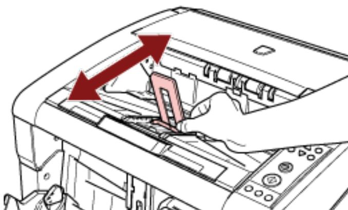
Per scandire documenti più lunghi del formato A3, estrarre completamente l'estensione dello scivolo e l'estensione del vassoio.
