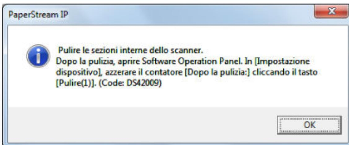
Verificare il messaggio e sostituire conseguentemente il materiale usurato o eseguire la pulizia. Quando si clicca il tasto [Ignora], le istruzioni per la pulizia scompaiono e la scansione continua. È possibile continuare la scansione per un po', tuttavia si consiglia di sostituire i materiali usurabili al più presto.
