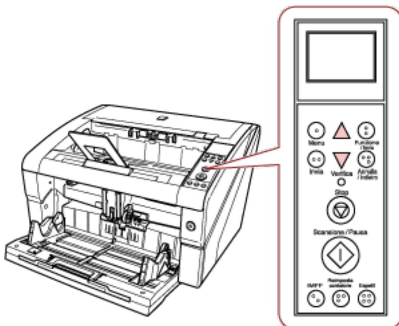
Quando [Forza separazione carta] viene visualizzato con un tasto di scelta rapida, la schermata torna a [Pronto] dopo un determinato periodo di tempo. È possibile configurare questo periodo di tempo in [18: Tempo di ripristino] del pannello di comando.
