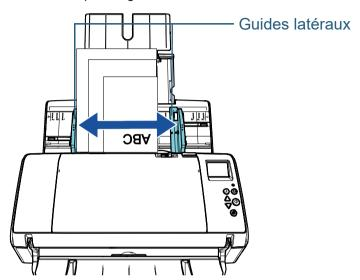
Verrouillez l'un des guides latéraux. Dans ce cas, déplacez le verrou du guide latéral gauche pour verrouiller ce dernier.
