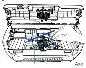
2 Faites tourner la bague sur l'axe dans la direction de la flèche.
