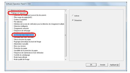
3 Pour désactiver ou activer [Détection de stries verticales]. Si vous sélectionner [Activer], le scanneur détecte les lignes verticales (poussière sur la vitre) lors d'une numérisation avec l'AAD.
