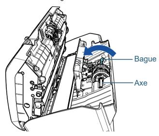
3 Soulevez la bague dans la direction ① (environ 5 mm),faites glisser l'axe dans la direction ② afin d'extraire l'extrémité de la fente puis soulevez l'axe dans le sens ③ afin de le retirer.
