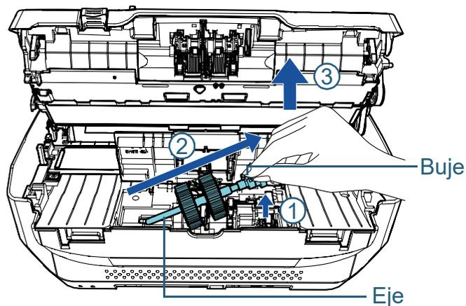
5 Retire los dos rodillos de recogida del eje uno por uno.
