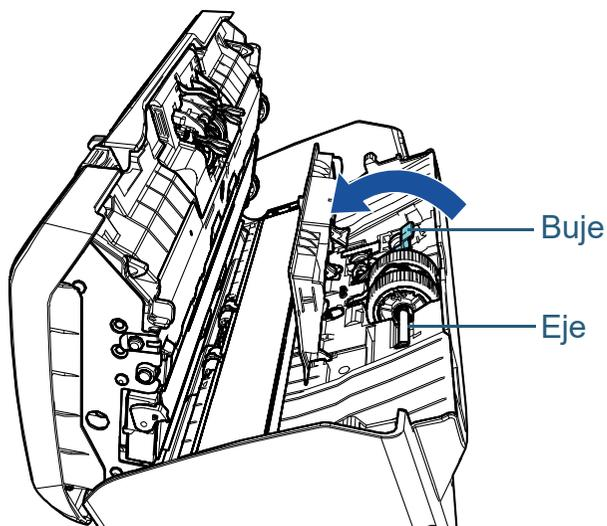
3 Levante el buje en dirección ① (unos 5 mm), deslice el eje en dirección ② para extraer el extremo delantero de la ranura y, a continuación, levante el eje en dirección ③ para retirarlo.
