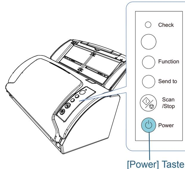
⇒ Der Scanner wird eingeschaltet und die [Power] Taste leuchtet grün. Während der Initialisierung ändert sich die Funktionsnr.-Anzeige auf dem Bedienfeld in folgender Reihenfolge: "8" → "H" → "0" → "1". Der Scanner ist bereit, wenn die Funktionsnr.-Anzeige "1" angezeigt wird.
