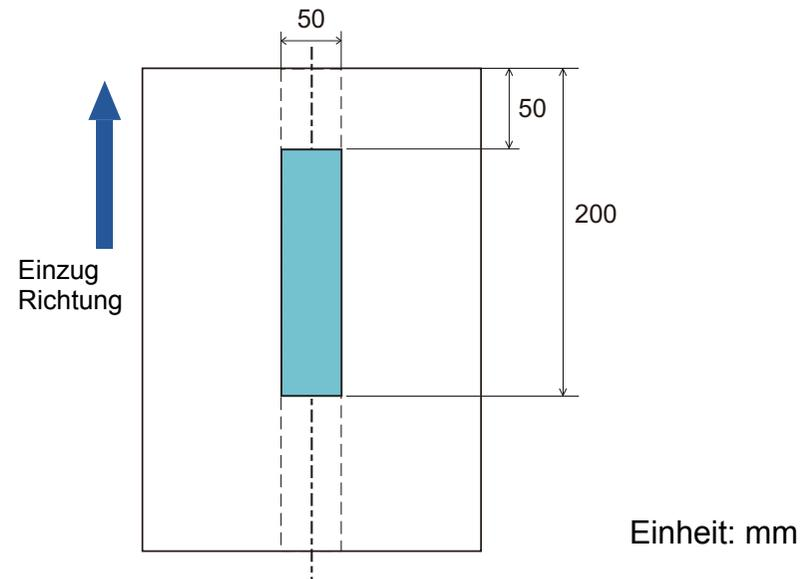
Die Mehrfacheinzugserkennung wird nur für die hellblau dargestellten Bereiche ausgeführt.
