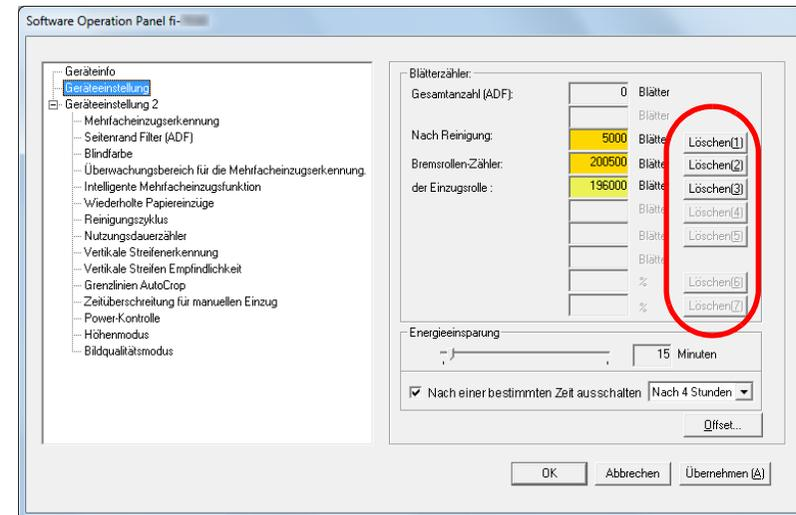
⇒ Der Zähler wird auf "0" zurückgesetzt.
