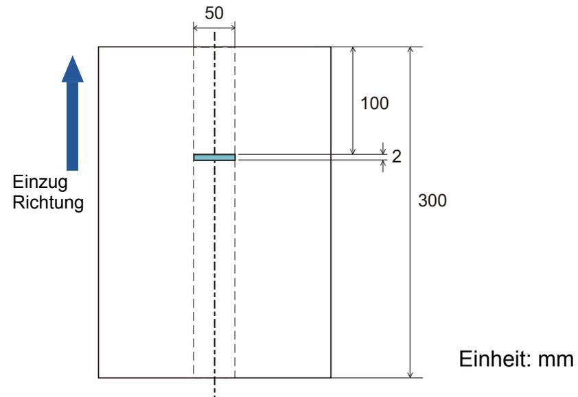
Da der Erkennungsumfang (Länge) kleiner ist als 5 mm, können Mehrfacheinzüge nicht korrekt erkannt werden.
