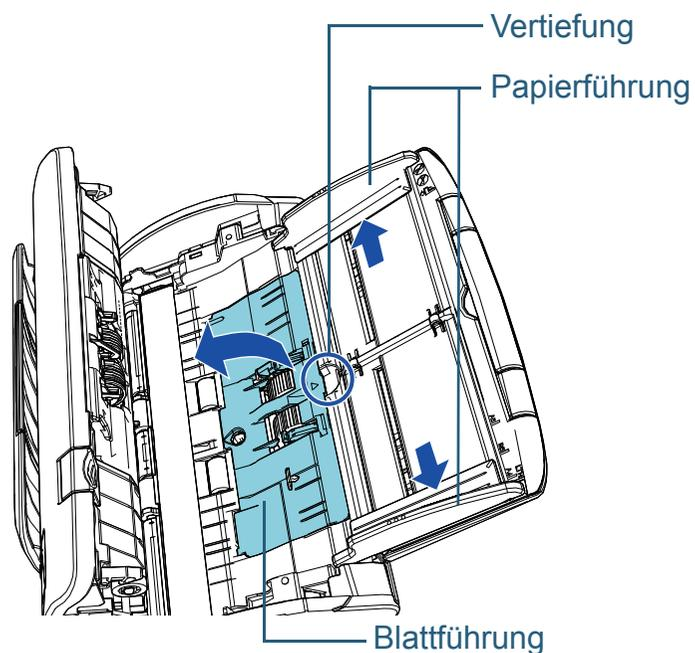
2 Drehen Sie die Halterung in Pfeilrichtung auf der Achse.
