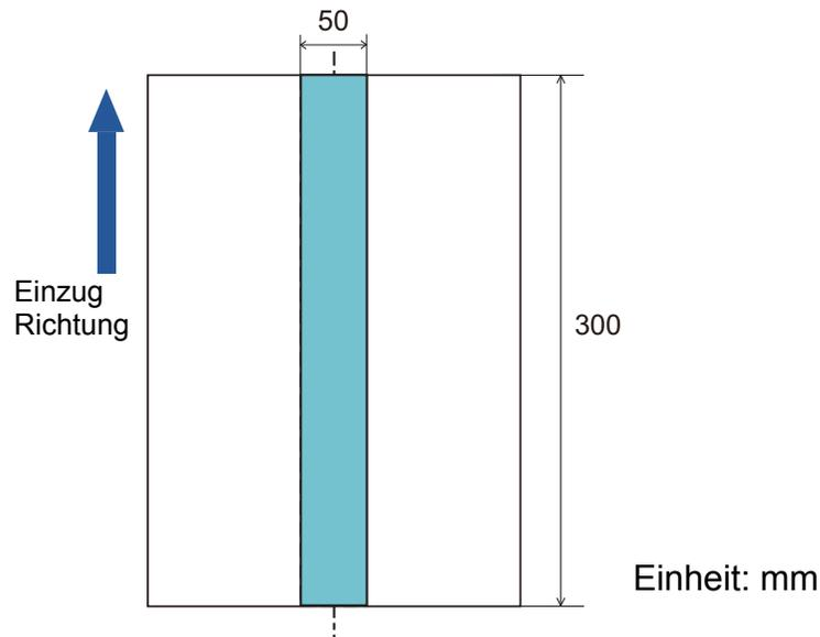
Die Mehrfacheinzugserkennung wird nur für die hellblau dargestellten Bereiche ausgeführt.
